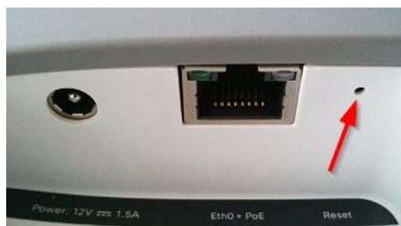
Slika 54. Reset button na Meraki MR33AP-u
