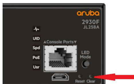
Slika 59. Reset tipka na Aruba 2930F preklopniku
