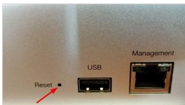
Slika 58. Reset tipka na Meraki MX100 UTM uređaju
