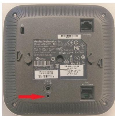
Slika 60. Reset tipka na Aruba IAP
