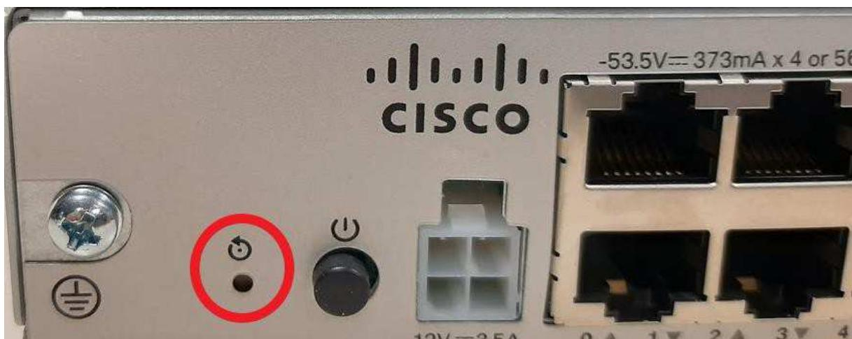
Slika 42: Usmjerivač Cisco – tipka reset
